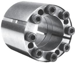
Selbstzentrierender Spannsatz mit hoher Rundlaufgenauigkeit für höchste Belastungen. Die zweifachen Kegelflächen mit kleinen Kegelwinkeln sind selbsthemmend und benötigen relativ große Spannwege. Zur Demontage müssen Abdrückschrauben benutzt werden. Die Innenspannringe erfordern zum Lösen einen axialen Freiraum ( $s = 0,02 \times d$ )
