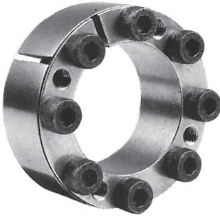
Der dreiteilige Spannsatz ist eine alternative Ausführung zum MLC 1000 mit kleineren Außendurchmessern und ebenfalls für mittlere Drehmomente. Die vorzentrierte Einbaulage erleichtert die Montage und bewirkt eine sehr gute Rundlaufgenauigkeit. Wegen der relativ kleinen Kegelwinkel muss bei der Demontage die Spannverbindung durch Abdrückschrauben gelöst werden. Dabei wird der vordere Kegelring nach außen gezogen.
