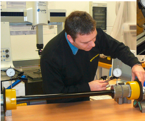
Rundlaufprüfung der Tragrollen Runout test of conveyor rollers
