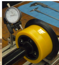
Montage von modularen Tragrollen mit doppelseitiger Horizontalpresse Assembly of modular conveyor rollers with double-action horizontal press
