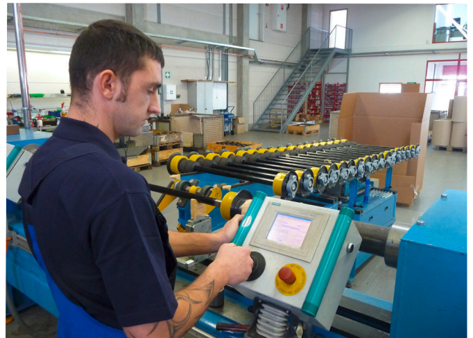
Montage von modularen Tragrollen mit doppelseitiger Horizontalpresse Assembly of modular conveyor rollers with double-action horizontal press
